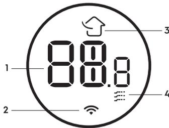
1. Индикатор таймера, температуры и кодов ошибок
