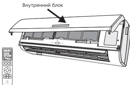
2. Регулирование направления потока воздуха в горизонтальной плоскости выполняется поворотом вертикальных жалюзи с пульта дистанционного управления с помощью клавиши SWING.
