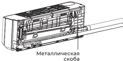
**Вариант 2:** правый, вместе с трубопроводом хладагента, дренажной трубой и соединительными кабелями. Для плотного прижима воздуховода и труб, используйте комплектную металлическую скобу.
