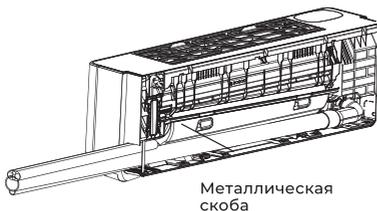
**Вариант 3:** вывод назад, под отдельное отверстие для воздуховода.
